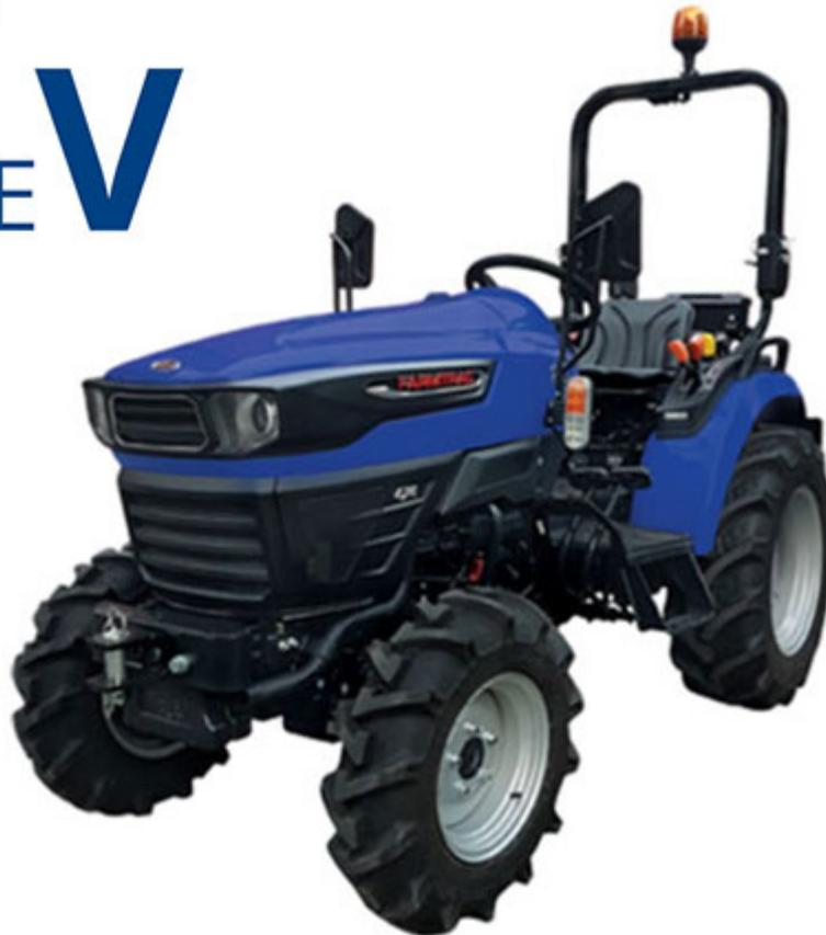
Der robuste **3-Zylinder Dieselmotor** von Mitsubishi ist wassergekühlt und erfüllt die Abgasnorm **Stufe V**. Der zuverlässige **4-Takt-Motor** ist durch die einteilige Motorhaube extrem **wartungsfreundlich**. Der Kühlergrill kann leicht entfernt und gereinigt werden.
