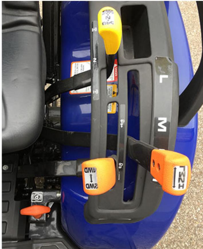
Das mechanische **9V+3R Getriebe** lässt sich sanft schalten und kann höhere Drehmomente aufnehmen. Der Allradantrieb ist mechanisch zuschaltbar. Die Zapfwelle bietet 2 Geschwindigkeiten (**540/540e U/min.**). Den FT26 gibt es auch mit **Hydrostat-Getriebe**.
