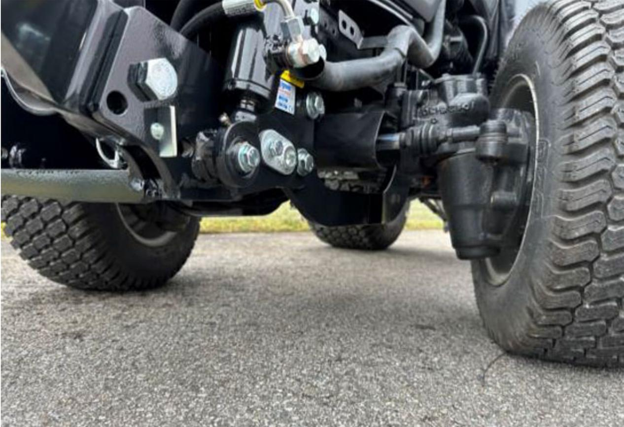
Die präzise Zugkraft- und Lagereglung des Frontkrafthebers ermöglicht effiziente Steuerung der Anbaugeräte. Die **Unterlenker sind klappbar** und lassen sich zu beiden Seiten einstellen.
