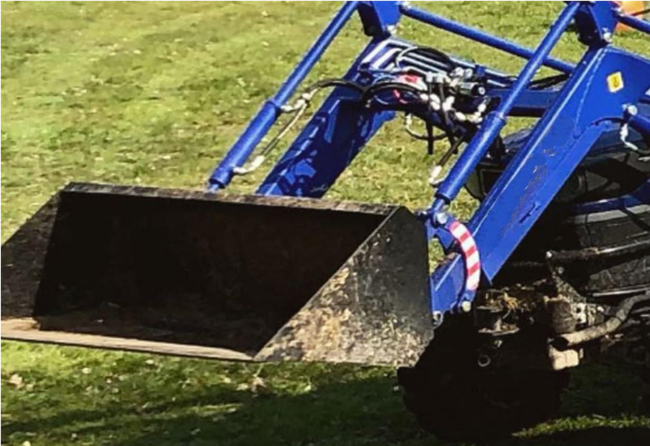
Ausgestattet mit Parallelführung, 2. hydraulischem Steuerkreis, Bedienung über Joystick, werkzeugloser Schnellwechsler für Anbaugeräte, robuster Anbaurahmen mit Hinterachsabstützung.
