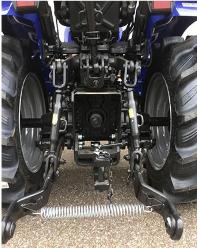
Die Heckzapfwelle mit 2 (540/ 540e) Geschwindigkeiten ist serienmäßig bei allen Modellen verbaut. Bei Modellen mit Hydrostat-Antrieb ist eine Zwischen- Achszapfwelle
