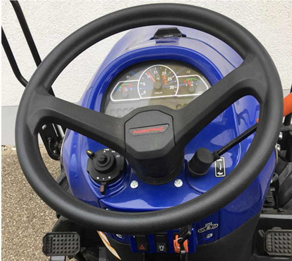
Die **Servolenkung** mit Hubzylindern für beide Lenkrichtungen ergibt eine gleichmäßige Kraftverteilung links wie rechts, einen **ausgezeichneten Wendekreis** und verringert durch mühelose Manövrierbarkeit die Ermüdung des Fahrers. Weil Sicherheit die höchste Priorität hat.
