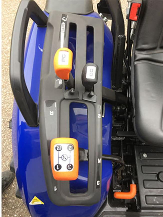
Der Antriebsstrang mit seitlichen Schalthebeln ist leicht zugänglich und bietet höhere Effektivität durch Wendigkeit und komfortable Bedienung. Die Hebel sind **ergonomisch** angebracht und behindern zudem nicht den Zugang zum Fahrersitz.
