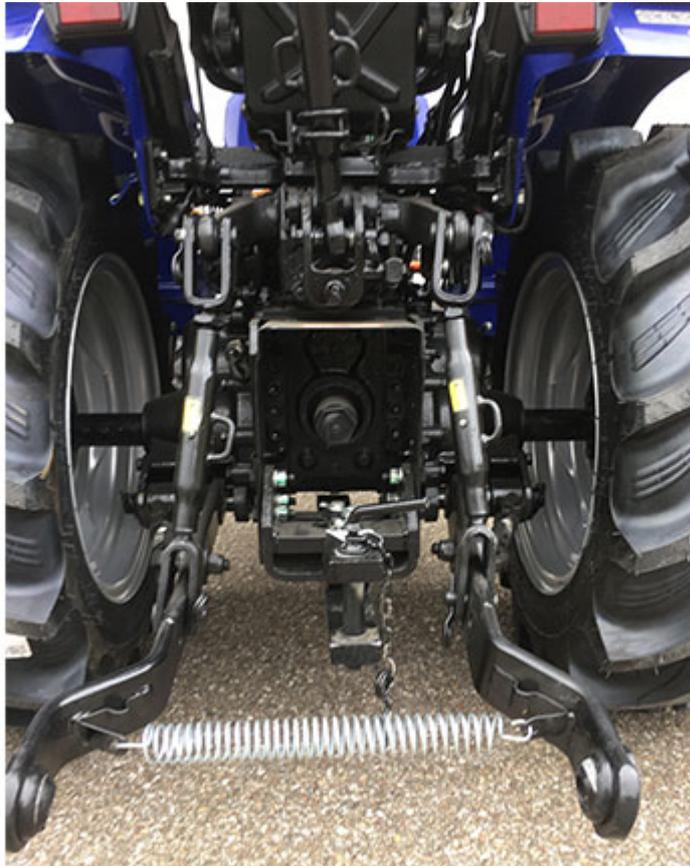
Der leistungsstarke **Dreipunkt-Heckkraftheber** der **Kategorie I** mit einer Hubkraft von 750 kg ist intuitiv bedienbar und erlaubt den Betrieb einer breiten Palette von selbst schweren
